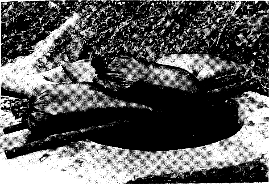
圖十四 收集底部溶液裝入袋內，待水分瀝乾至半成品
